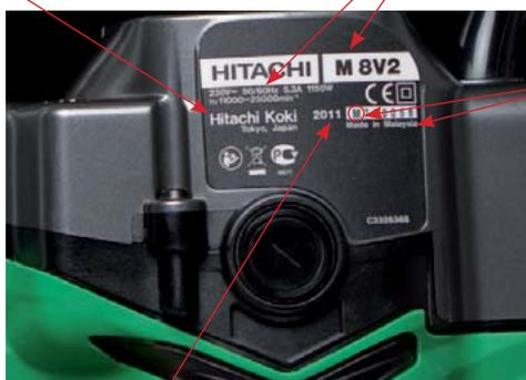
Под серийным номером обязательно указана страна производства. Она же зашифрована буквенным обозначением в серийном номере:
