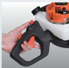
Когда ножи движутся, кнопка-фиксатор не нажимается. Оператор должен отпустить дроссельный рычаг, чтобы изменить угол рукоятки.
