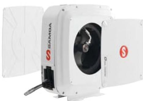
Катушка очень легка в обслуживании. Снятие одной из боковых панелей обеспечивает полный доступ для осмотра шарнира, замены шланга или корректировки нагрузки силовой пружины. Снятие другой боковой панели обеспечивает полный доступ к храповому механизму. Любое сервисное обслуживание может быть проведено без демонтажа катушки.
