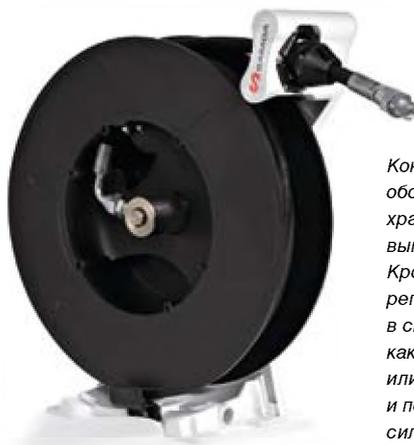
Конструкция с одной опорой упрощает обслуживание: замену шланга и осмотр храпового механизма и шарнира можно выполнять, не снимая катушку. Кроме того, натяжение силовой пружины можно регулировать на месте при наличии давления в системе и без необходимости использования каких-либо инструментов или снятия запорного или контрольного клапана, независимо от высоты и положения монтажа катушки. Натяжение силовой пружины можно увеличивать, просто добавляя витки шланга на бобину и уменьшать, убирая их.
