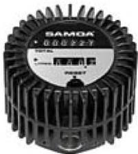
Счетчик с овальными шестернями с механическим одомером для смазочных материалов до SAE 140. Сбрасываемый подсчет до 999,9 л и не сбрасываемый сумматор. Счетчики калиброваны на заводе и заключены в резиновый защитный кожух.
