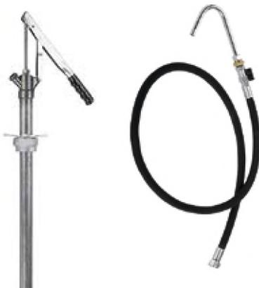
Рычажные насосы для перекачки высоковязких смазочных материалов. В комплекте – регулируемый по высоте переходник 2" для монтажа непосредственно на бочки, крышки или контейнеры. Стальные всасывающая труба, обратный клапан и поршень, уплотнения из NBR (бутадиен-нитрильный каучук). Производительность: 100 см<sup>3</sup> за один ход. Резьба на выходе: 3/4" BSP (M).
