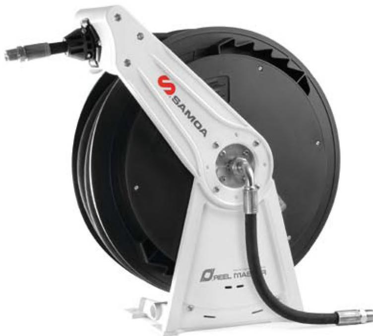
Катушка из алюминия и композитных материалов с одной опорой для перекачки воздуха, воды, масла, антифриза, жидкости для омывателя ветрового стекла, холодной и горячей воды и консистентной смазки под высоким давлением для шлангов длиной 15 м диаметром 1/2".
