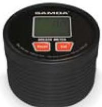
Линейные счетчики с овальными шестернями с электронным цифровым ЖК-дисплеем. Счетчик имеет два отдельных дисплея: сбрасываемый 4-разрядный дозирочный дисплей 6-разрядный постоянный сумматор. Счетчики калиброваны на заводе и могут быть перекалиброваны на месте с целью повышения точности. Единицы измерения: литры, кварты, пинты, галлоны США. Счетчики совместимы со смазочными материалами до SAE 240, дизельным топливом и раствором гликоля.
