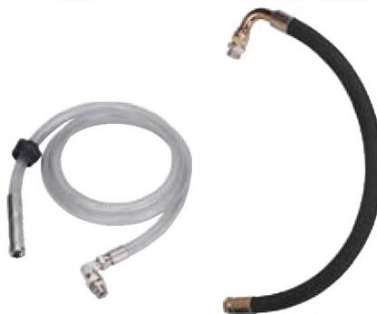
**367 011: Усиленный пружиной прозрачный всасывающий шланг длиной 3 м для бочек 205 л и среднетоннажных контейнеров 1000 л.** Включает регулируемый по высоте переходник 2" и соединительное колено 90° 3/4" BSP (M) для подключения к короткому насосу.
