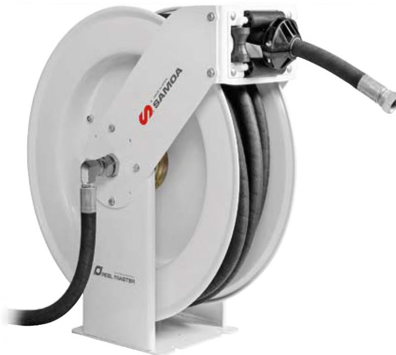
Сверхпрочная двухпорная металлическая катушка. Применяется для подачи воздуха, воды, антифриза, адблю, смазочных материалов, дизеля и консистентной смазки под высоким давлением. Размер шланга 15 м диаметром 3/4" или 20 м диаметром 1/2".
